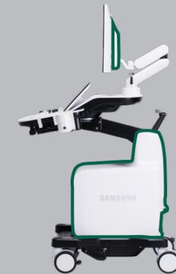
Plastique recyclé appliqué sur le corps du système
